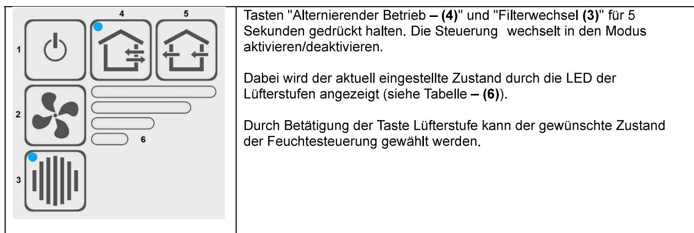
Erneutes drücken der Tasten "Alternierender Betrieb" und "Filterwechsel" für mind. 5 Sekunden speichert die gewählte Einstellung ab. Der Regler wechselt danach wieder in den Normalbetrieb.
